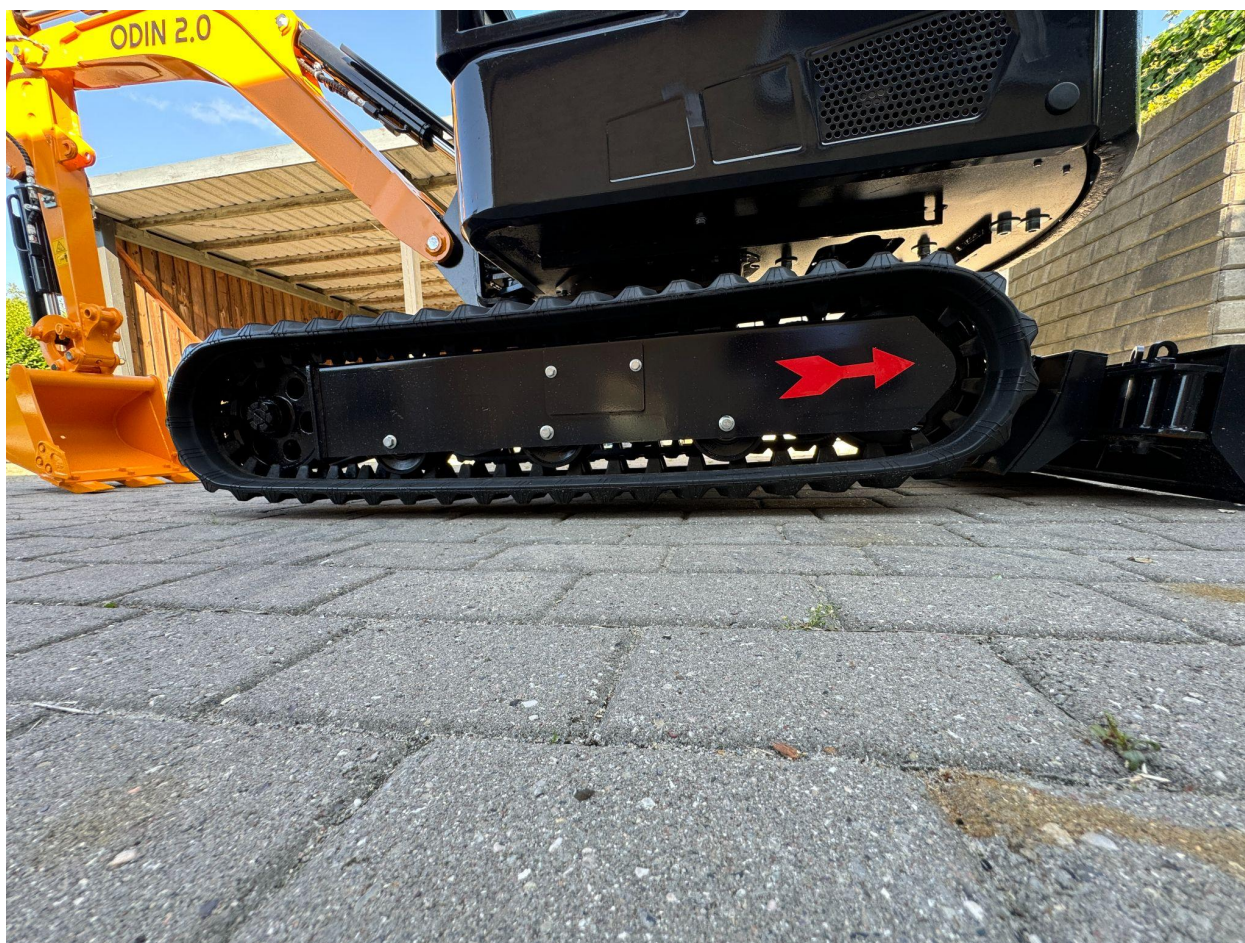
Illustration af en hævet undervogn for at skyde bælter ind eller ud, uden komplikationer.
